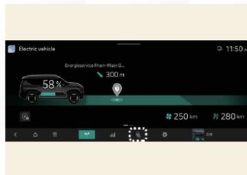
Seleccione el icono en la pantalla del sistema de infoentretenimiento. Permite establecer la fecha y la hora en las que se debe cargar la batería, la temperatura del control del climatizador y otras funciones diversas.
