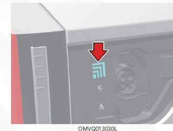
Al cargar la batería de alto voltaje, el nivel de carga puede comprobarse desde el exterior del vehículo.
